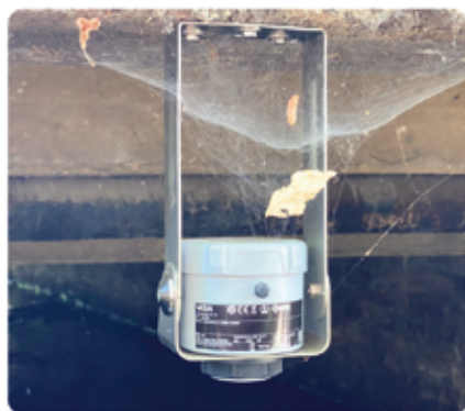
VEGAPULS AIR 41 autonome sans fil avec communication LTE-M ou LoRaWAN
